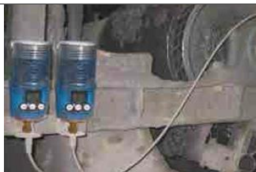
Dispensadores automáticos Lubri-Cup™ EM para áreas de difícil acceso.
