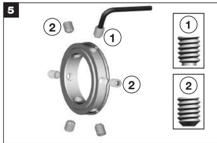
**IMPORTANTE:** PRIMERO se deben apretar todos los tornillos de fijación de macho largo de 1/4 ① y por último se deben apretar los tornillos de fijación de macho corto ②. Las ubicaciones de los tornillos de fijación de macho largo de 1/4" se marcan con una muesca en el diámetro exterior del anillo de bloqueo, al lado de los orificios para los tornillos.
