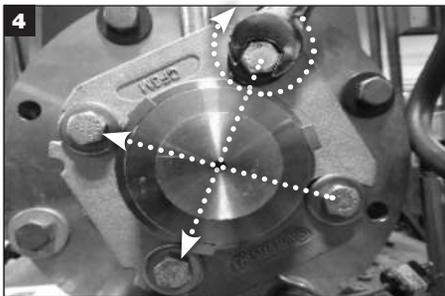
Apriete uniformemente los pernos del sombrerete. **IMPORTANTE:** Se deben apretar los pernos de la brida antes de apretar los tornillos de fijación en el eje. El apriete de los pernos de la brida depende de la aplicación. **IMPORTANTE:** Las conexiones de las tuberías no deben hacerse antes de apretar los pernos de la brida.
