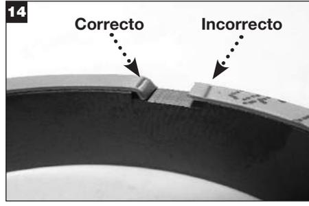
Asegúrese de que las almohadillas estacionarias estén correctamente instaladas, con la sección colgante en los bordes de separación plegada hacia los laterales de las ranuras.
