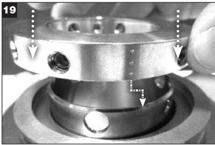
Coloque el anillo de bloqueo en la parte superior del cilindro y alinee las tres muescas verticales en el diámetro externo del anillo de bloqueo con la muesca del borde superior del cilindro.
