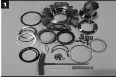
Herramientas requeridas para el ensamblaje del sello: Llave hexagonal y dos tipos de grasa (suministradas con el sello); paño sin pelusa, tenacillas o un pico delgado (suministrados por el cliente; para la instalación de los O-Rings y el tubo conductor). Limpie todos los componentes metálicos con un solvente aprobado, incluidas todas las superficies de las juntas y los O-Rings. Coloque los componentes metálicos y todos los componentes de repuesto del sello sobre una superficie limpia y seca.
