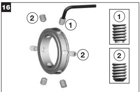
Instale los tornillos de fijación de macho largo de 1/4" (1) en los orificios para los tornillos marcados con una muesca en el diámetro exterior del anillo de bloqueo. Instale los tornillos de fijación de macho corto (2) en los orificios restantes del anillo de bloqueo. **IMPORTANTE: Los tornillos no deben sobresalir al diámetro interior del anillo de bloqueo antes de instalarlo en el cilindro del sello.**
