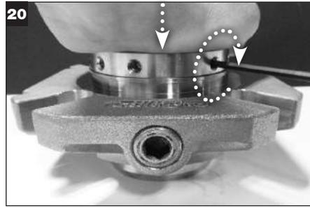
Presione delicadamente sobre la parte superior del anillo de bloqueo y apriete los tornillos de fijación de macho largo de 1/4" y luego los tornillos de fijación de macho corto con la llave hexagonal suministrada con el sello.
