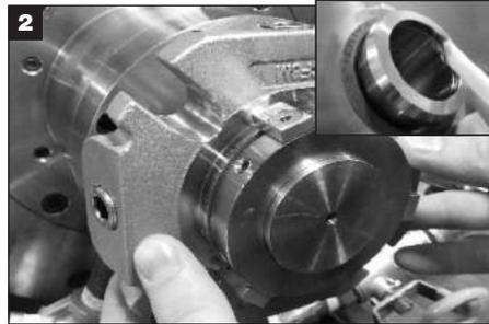
Aplique una película delgada de grasa blanca al O-Ring/eje (V) y deslice el sello sobre el eje empujando sobre la brida. **PRECAUCIÓN:** Asegúrese de que todos los tornillos de fijación estén apretados en el cilindro, pero que no sobresalgan en el diámetro interno del mismo.
