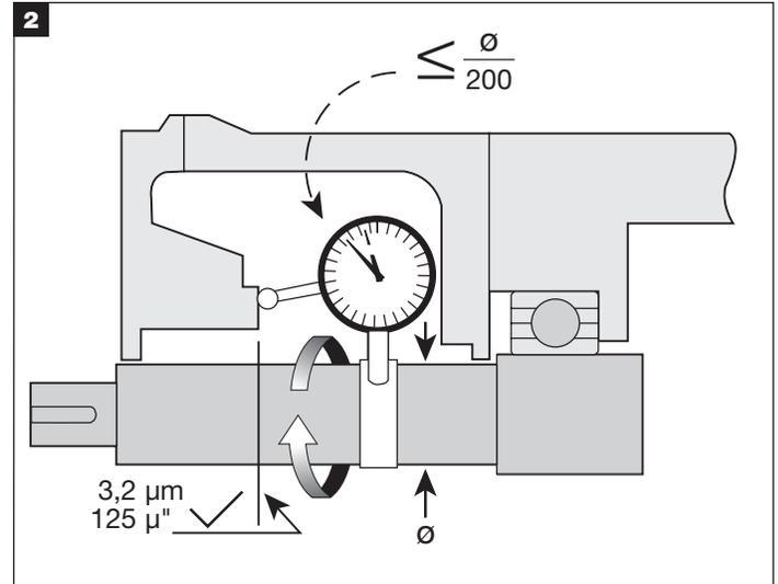
Si es posible, conecte un indicador de cuadrante en la base al eje y rote tanto el indicador como el eje lentamente mientras lee el descentramiento de la cara de la caja. La mala alineación de la cara de la caja con relación al eje no debe exceder un valor de 0,005 mm TIR por mm (0,005 pulg. por pulgada) de diámetro del eje.
