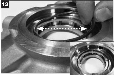
Aplique una película delgada de **grasa blanca** al O-Ring de la cara estacionaria (X) e instálelo en la ranura de la brida por arriba del conjunto de placa del seguidor.
