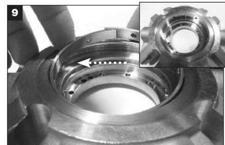
**Para sellos con la opción de inyector:** Invierta la brida. Comprima y superponga los extremos del inyector, posicione las separaciones frente al puerto F (lavado) e instale en la ranura de la brida. **IMPORTANTE:** El inyector debe colocarse a presión en posición. Asegúrese de que los extremos divididos no se superpongan al quedar completamente instalados; haga ajustes hasta que los extremos se toquen.
