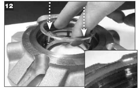
Alinee los pasadores de la placa del seguidor con los orificios marcados que se han llenado con **grasa 635 SXC** en la brida y presione la placa hacia abajo en la brida hasta que la placa del seguidor quede apoyada sobre los resortes.
