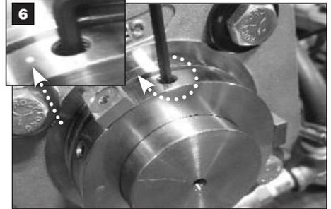
Apriete uniformemente tres tornillos de fijación de macho largo de 1/4 ① (consulte la imagen insertada, marcada con una muesca) con la llave hexagonal provista.
