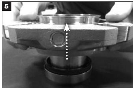
Separe el cilindro de la brida y aparte el cilindro.
