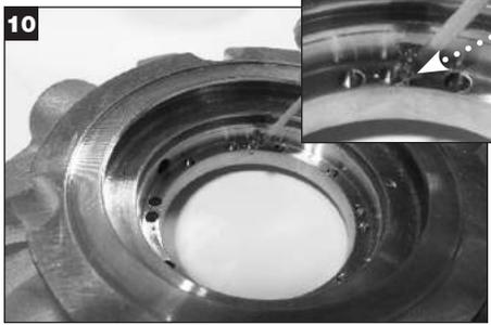
Llene los cuatro (o dos, según el tamaño del sello) orificios espaciados de manera uniforme, marcados con muescas, con la **grasa 635 SXC** suministrada con el sello. Limpie el exceso de grasa. **Sugerencia Útil:** Utilice la placa del seguidor como guía para confirmar que la grasa se aplicará en los orificios correctos.
