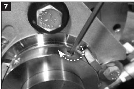
Apriete uniformemente los tornillos de fijación de macho corto ② con la llave hexagonal provista. **IMPORTANTE:** Después de haber apretado a mano todos los tornillos de fijación, vuelva a apretar con una llave de apriete:
