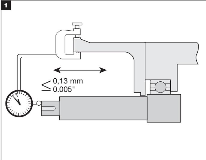
Si resulta práctico, coloque la punta del indicador de cuadrante en el extremo del cilindro del eje o sobre un paso del eje para medir la holgura en el extremo. Como alternativa, empuje y tire del eje en dirección axial. Si los cojinetes están en buenas condiciones, la holgura en el extremo no debiera exceder un valor de 0,13 mm (0,005").
