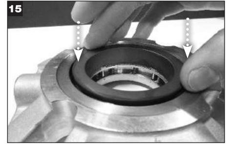
Alinee las ranuras en la cara estacionaria con las lengüetas de la placa del seguidor y comprima suavemente la cara estacionaria hacia abajo hasta que quede completamente asentada. **PRECAUCIÓN: Una incorrecta alineación resultará en un astillado de los bordes de la ranura de la cara.** Limpie la cara estacionaria con un paño sin pelusa y un solvente para limpieza aprobado que cumpla con las normativas locales y de la planta.
