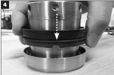
Alinee la marca en la cara rotatoria con la muesca del cilindro. Deslice la cara rotatoria hacia abajo hasta llegar al cilindro y comprima delicadamente hasta que quede asentada. Las lengüetas conductoras del cilindro engranan en las ranuras de la cara rotatoria. **PRECAUCIÓN: No comprima el tubo conductor.**
