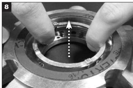
Retire el conjunto de seguidor para quitarlo de la brida y apártelo.
