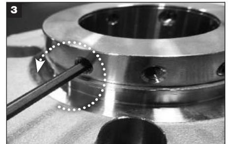
Retire todos los tornillos de fijación de macho corto y largo de 1/4" para quitarlos del anillo de bloqueo y deséchelos.
