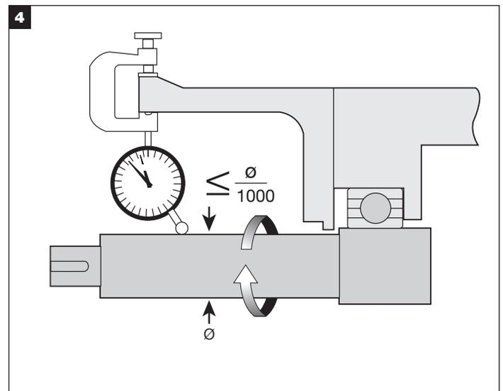
Use un indicador de cuadrante para medir el descentramiento del eje en el área donde quedará instalado el sello. El descentramiento no debe exceder un valor de 0,001 mm TIR por mm (0,001 pulg. por pulgada) de diámetro del eje.
