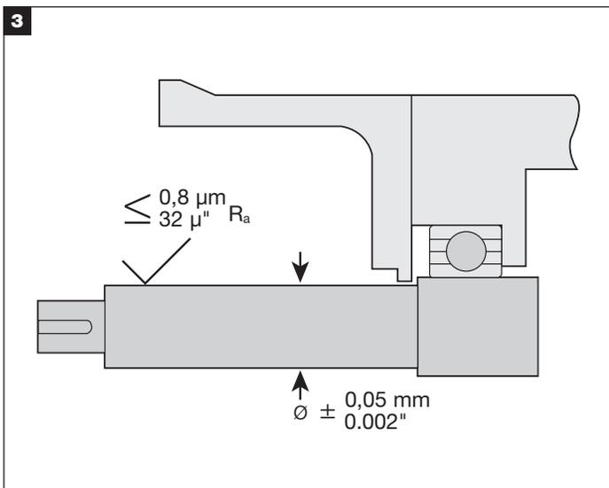
Elimine todos los rebordes afilados, rebabas y raspaduras en el eje, especialmente en áreas donde el O-Ring se deslizará, y pula si es necesario para lograr un acabado de 1,1 micrones (45 micropulgadas) Ra. Asegúrese de que el diámetro del eje o del cilindro esté dentro de 0,05 mm (0,002") del valor nominal.
