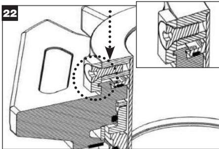
Presione hacia abajo la parte superior de la brida para comprimir el conjunto y gire cada clip de centrado para engranar la ranura en la parte superior de la brida, y apriete manualmente el tornillo de cabeza plana del clip de centrado. Repita este paso para todos los clips de centrado. Vuelva a apretar con una llave de apriete:
