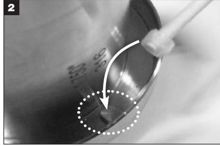
Recoja el tubo conductor (use las tenacillas si es necesario) e instálelo en cada una de las lengüetas del conjunto de seguidor. Asegúrese de que el tubo conductor quede completamente asentado en las lengüetas.
