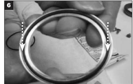
**Para sellos con el kit del buje:** Aplique una película delgada de grasa blanca al O-Ring (Y) e instálelo en la ranura del buje de bronce. **IMPORTANTE:** Asegúrese de que el O-Ring quede completamente asentado y firme dentro de la ranura correspondiente. El O-Ring podría ser demasiado grande al instalarlo y en ese caso, será necesario esforzarse para insertarlo.
