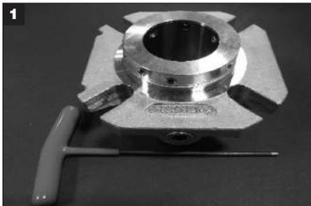
Herramientas requeridas para el desensamblaje del sello: Llave hexagonal (**suministrada con el sello**); tenacillas y un pico curvado (**suministrados por el cliente; para desmontar los O-Rings y el tubo conductor**).
