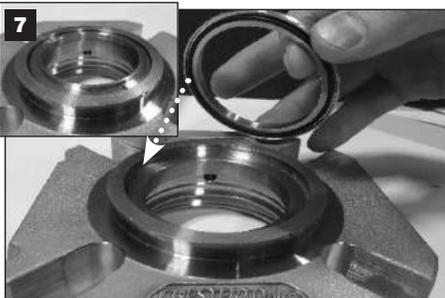
**Para sellos con el kit del buje:** Instale el buje en el orificio escariado de la brida con el O-Ring del buje (Y) orientado hacia abajo.
