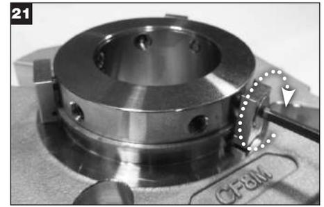
Instale los clips de centrado en el diámetro externo del anillo de bloqueo usando los tornillos de cabeza plana del clip de centrado.
