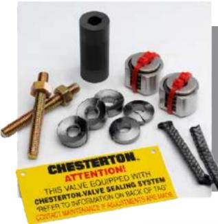
El sistema de Carga Viva de Chesterton proporciona ajustes automáticos del prensaestopas para mantener los juegos de empaquetaduras bajo presión constante, lo que reduce la posibilidad de que se revienten las empaquetaduras de la válvula debido a los aumentos repentinos de presión en la línea
