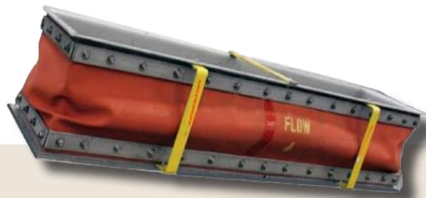
Las juntas de expansión textiles de Chesterton son ideales para aplicaciones de gases a bajas presiones y altas temperaturas. Trabajan a exposición directa a 538°C y con deflectores de temperatura hasta 1500°C.
