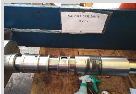
Limpieza y lubricación de los bujes ,anillos linterna simple y doble e instalación de Carga Viva.
