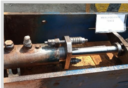
Se hace entrega al cliente del equipo con la instalación de carga viva a un torque de acuerdo al diseño de ingeniería y dejandola en condiciones de operación.
